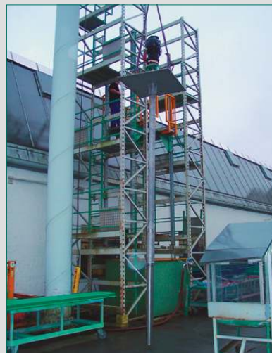
Leistungstests vor Auslieferung der NEMO® NM045BT unter Betriebsbedingungen
