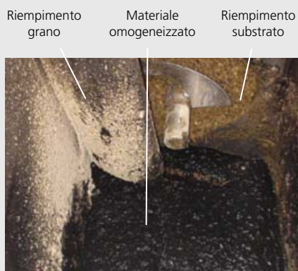
Veduta interna dell'imbuto della NEMO® B.Max®
